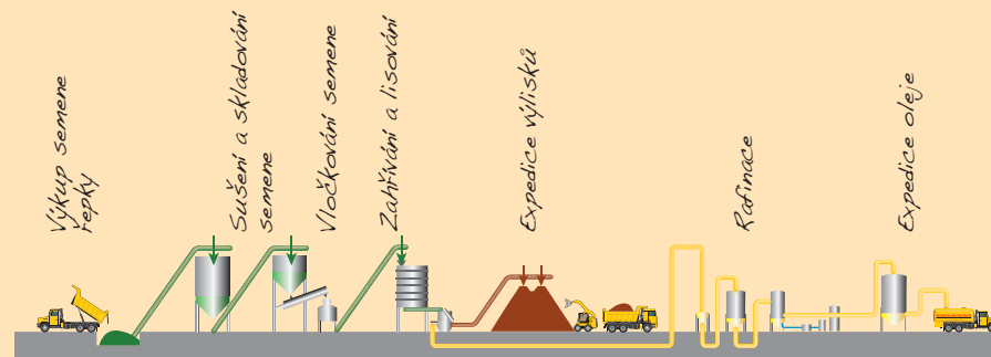
Lisování oleje za tepla s následnou rafinací
